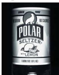
**Bouteille étiquetée :** inspection de la présence ou de l'absence de l'étiquette, étiquette et orientation correctes.
